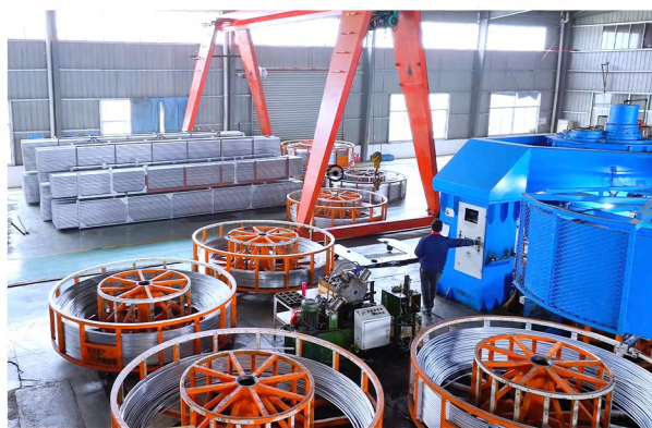
b. 倒立式盘拉机 (右) 起吊机 (中)
